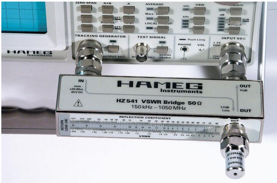
**IN-Anschluss** mit Tracking-Generator (HM 5014-2) verbunden (Signalquelle)
