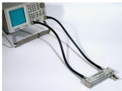
Setzt man die Messbrücke zusammen mit einem **Spektrum-Analysator eines anderen Herstellers** ein, muss man anstelle der Adapter zwei N-Kabel (optional) benutzen.
